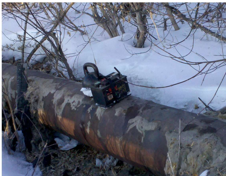
Рисунок 3.12 – Имитатор «инструмент на трубопроводе»
