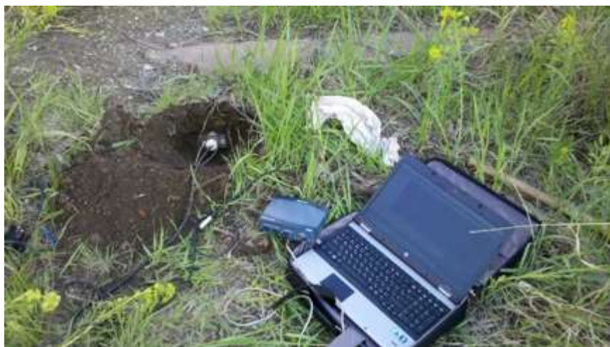
Рисунок 4.10 – Шурф глубиной 15 см с установленным внутри датчиком
