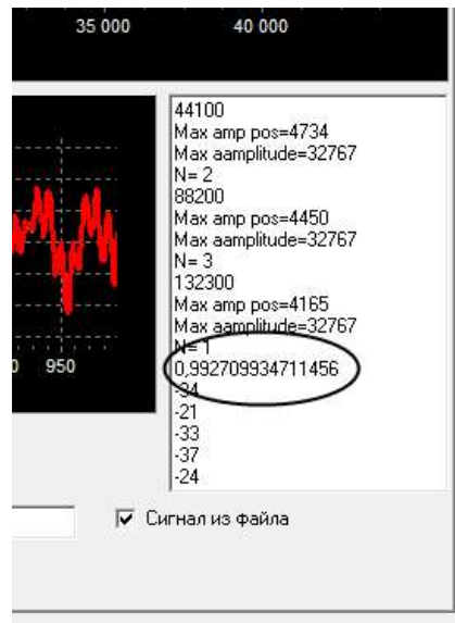
Рисунок 3.18 – Коэффициент корреляции при отсутствии нарушения
