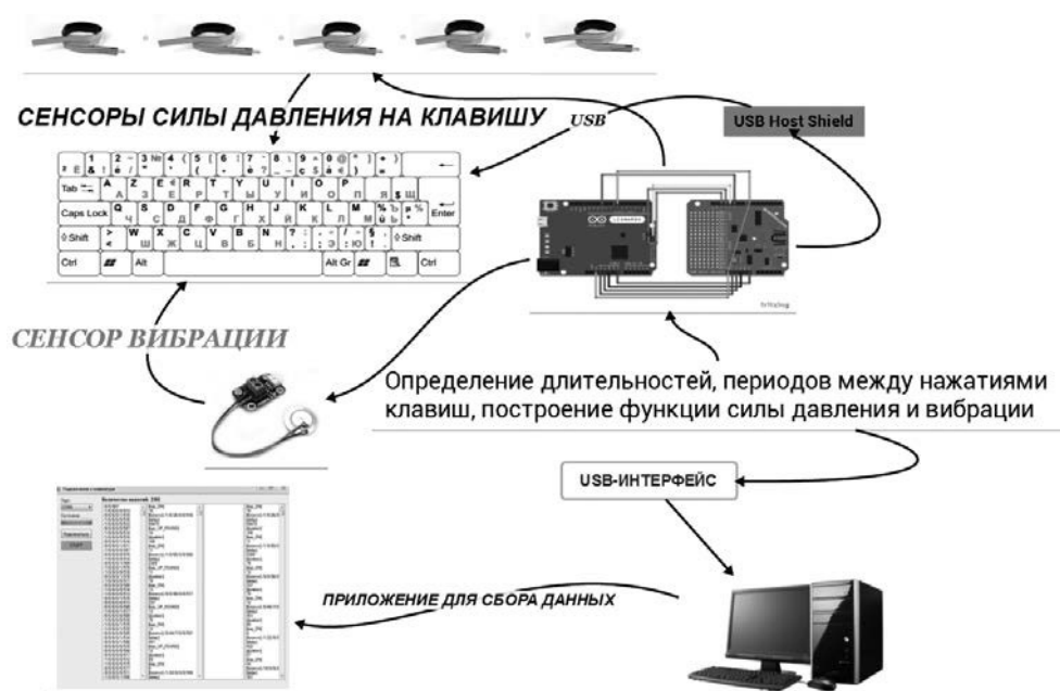
Рис. 1. Структурная схема программно-аппаратного комплекса для регистрации дополнительных признаков клавиатурного почерка от датчиков давления и вибрации
